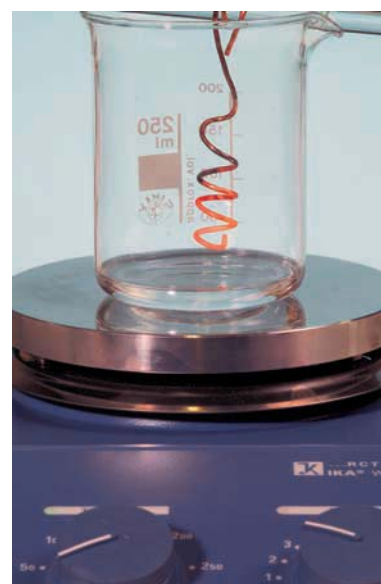
Fig. 3 – Tortillon de cuivre rougeoyant au-dessus des vapeurs d'alcool.
